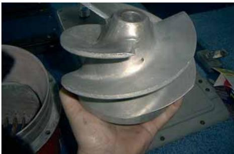
Рис. 6. Рабочее колесо центробежного ВД имеет коническую форму
